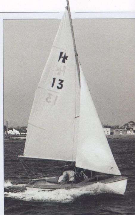
Construit en stratifié de polyester, le Haddock est le premier dériveur léger conçu par Philippe Harlé.
