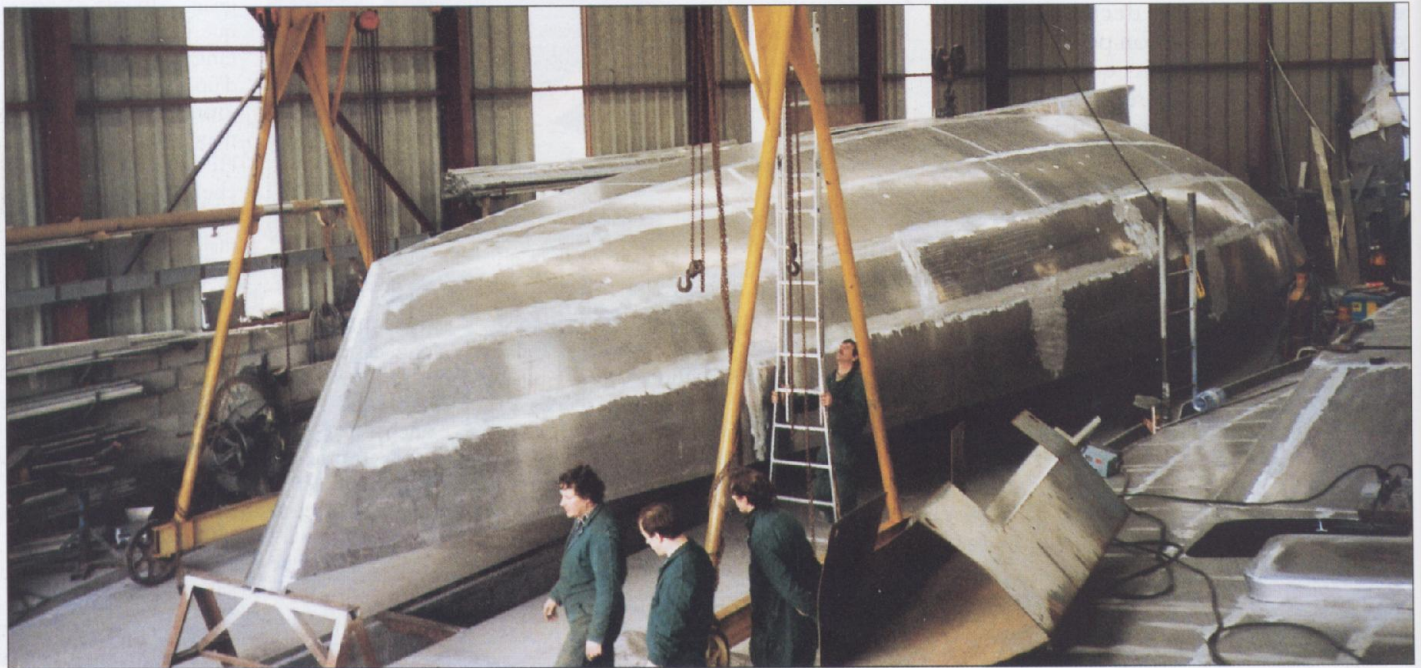
La construction de la coque du dériveur lesté de grande croisière Jeroboam , au chantier Garcia de Condé-sur-Noireau, en février 1984.
