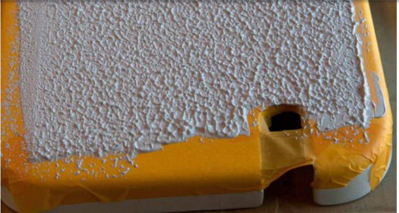
Appliqué directement sans aucun ponçage, le Kiwi Grip fait totalement disparaître la pointe-de-diamant. Nouvelle couleur, nouvelle finition, nouveau pont !
