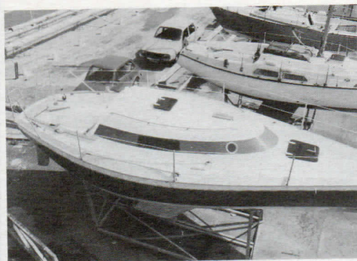
Le pont surélevé favorise le confort intérieur.
