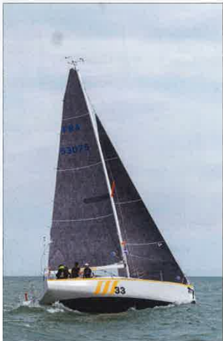
▲ Un seul étage de barres de flèche permet aux voiles d'avant de gagner en superficie.
